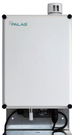
測量設備，用于監測惡劣地區空氣質量的細粉塵和污染物氣體（PM<sub>1</sub>、PM<sub>2.5</sub>、PM<sub>4</sub>、PM<sub>10</sub>、TSP、SO<sub>2</sub>、NO<sub>2</sub>、O<sub>3</sub>、CO）
